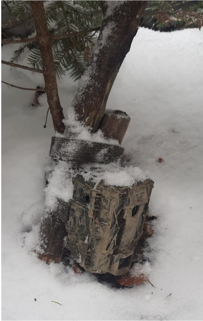
Imagini 3, 4: camere montate în teren cu antene rupte, mestecate de urs și mistreț
