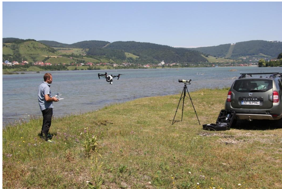
Test cu drona achiziționată de DAPNC în vederea cartării detaliate a vegetației submerse, a bancurilor de mâl și a dinamicii aluviunilor
